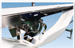
④ベルトが本体から取外せるようになります。
