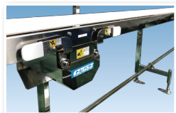
①固定用のノブボルトを緩めます。
