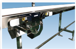
①原動部のカバーを取外します。
