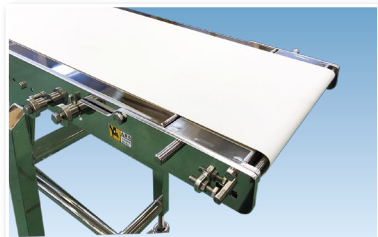
①固定用のノブボルトを緩めます。
