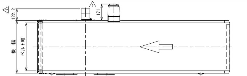
注1 本図はHH原動タイプ、ベルト幅500 mm、機長200 cm、機高650 mmの場合です
