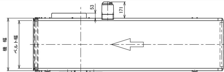
注1 本図はUH原動タイプ、ベルト幅500 mm、機長200 cm、機高650 mmの場合です
