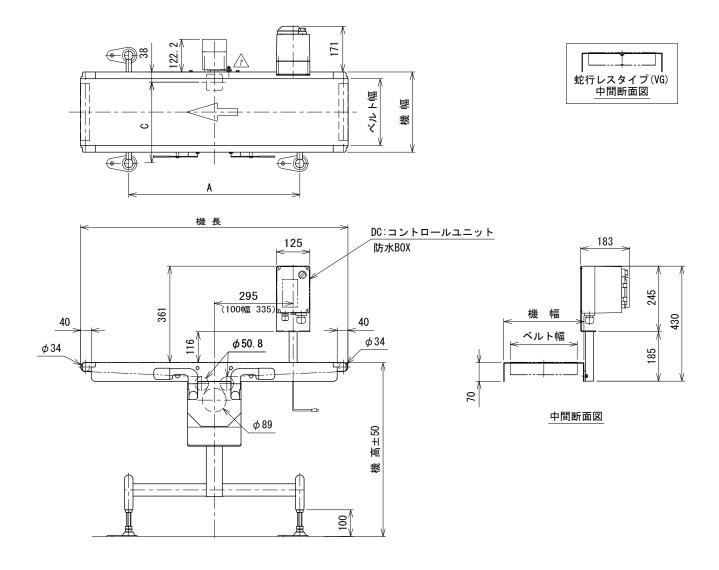
注1 本図はベルト幅250 mm、機長100 cmの場合です 注2 蛇行レスタイプ(VG)の場合、基本外観は変わりませんがテールローラ、ドライブプーリ、 トラフにベルト裏サン用のV溝が付きます
