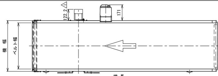
注1 本図はHH原動タイプ、ベルト幅500 mm、機長200 cm、機高650 mmの場合です
