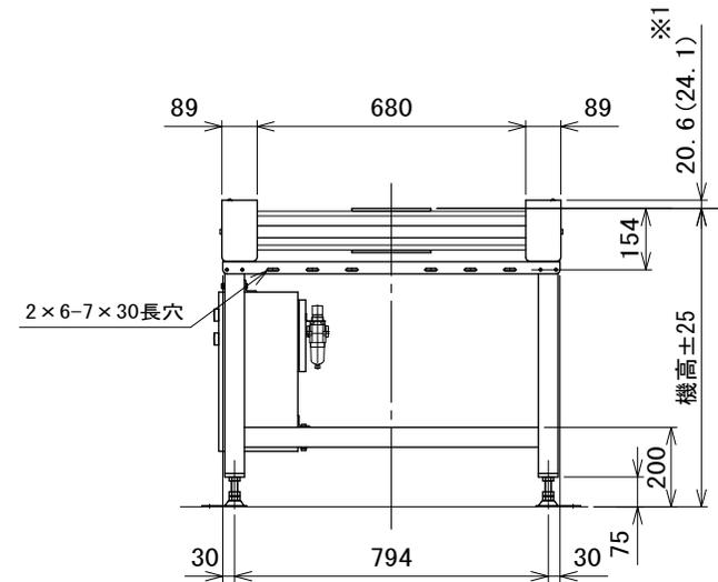
注1 本図は振り分け方式シリンダタイプ、モータ取付側L、搬送物検出センサ本体取付の場合です
