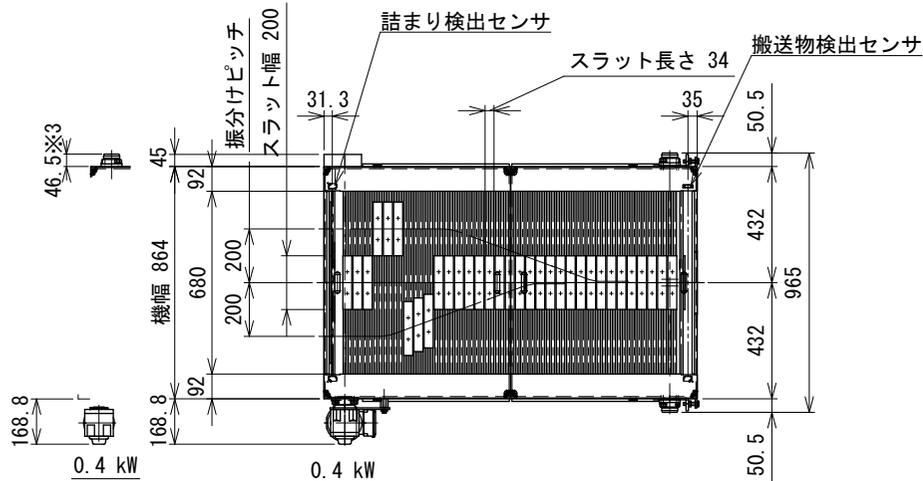
注1 本図はモータ取付側、汎用インバータ変速0.4 kW、搬送物検出センサ、詰まり検出センサ付の場合です
