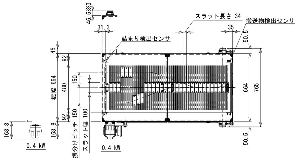
注1 本図はモータ取付側L、汎用インバータ変速0.4 kW、搬送物検出センサ、詰まり検出センサ付の場合です
