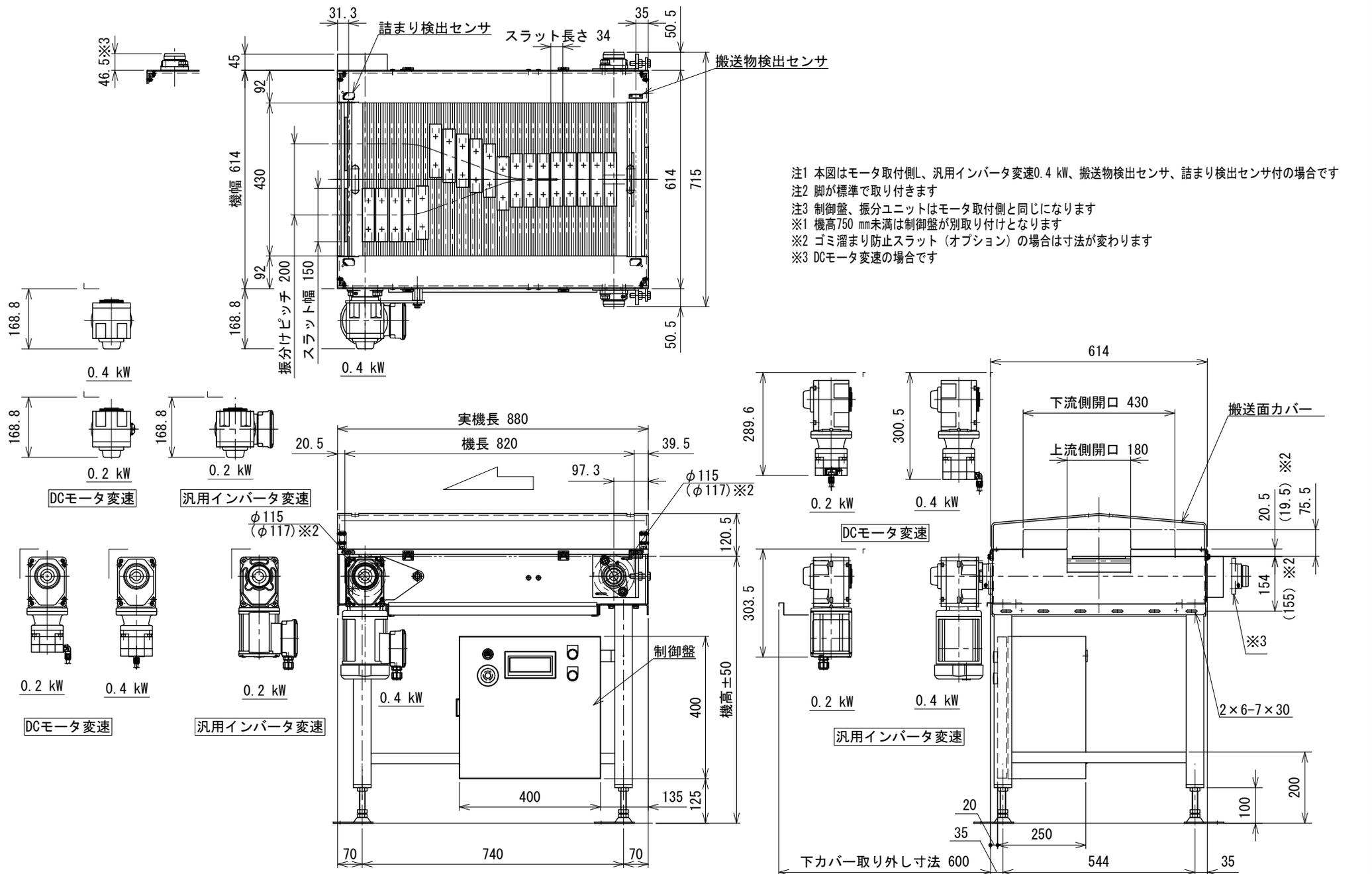
注1 本図はモータ取付側L、汎用インバータ変速0.4 kW、搬送物検出センサ、詰まり検出センサ付の場合です
