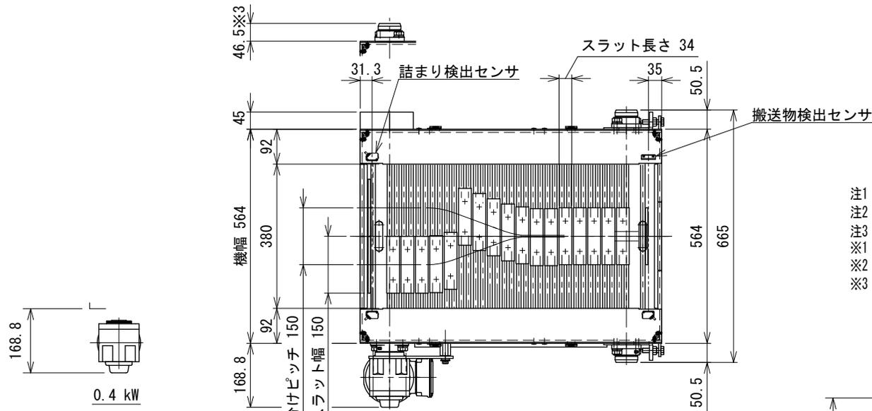
注1 本図はモータ取付側、汎用インバータ変速0.4 kW、搬送物検出センサ、詰まり検出センサ付の場合です
