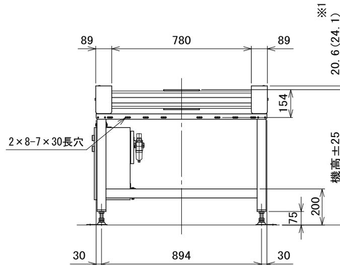
注1 本図は振り分け方式シリンダタイプ、モータ取付側の場合です
