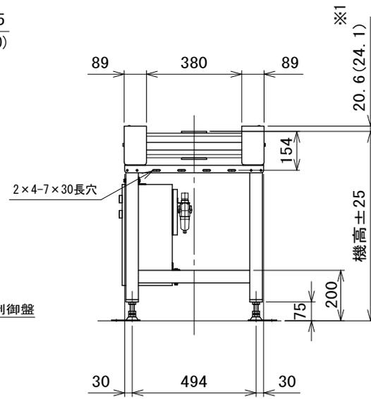
注1 本図は振り分け方式シリンダタイプ、モータ取付側Lの場合です
