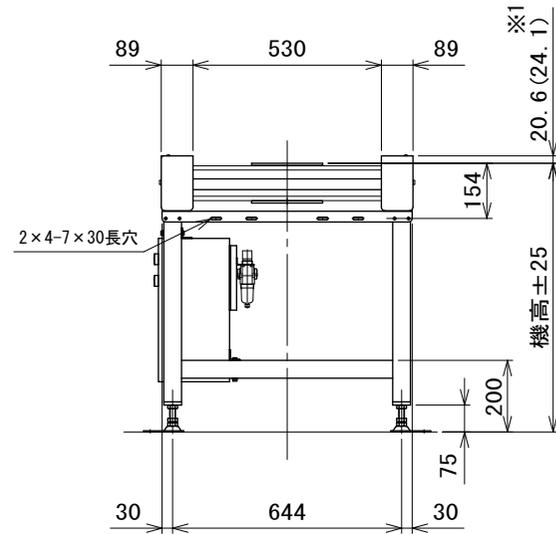
注1 本図は振り分け方式シリンダタイプ、モータ取付側Lの場合です
