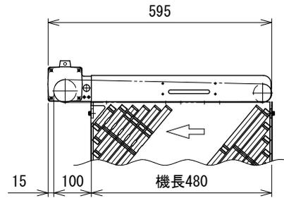
注1 本図はサイドベヤ取付方向R、汎用インバータ変速の場合です
