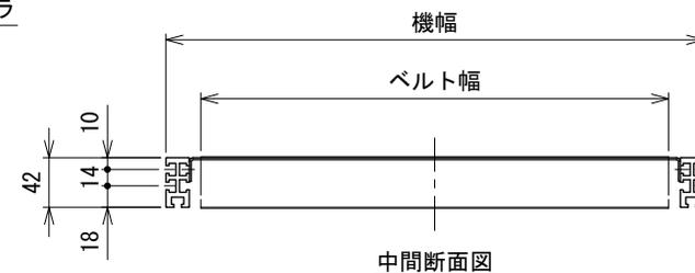
注1 本図は小型原動(SD2)タイプ、ベルト幅400 mmの場合です
