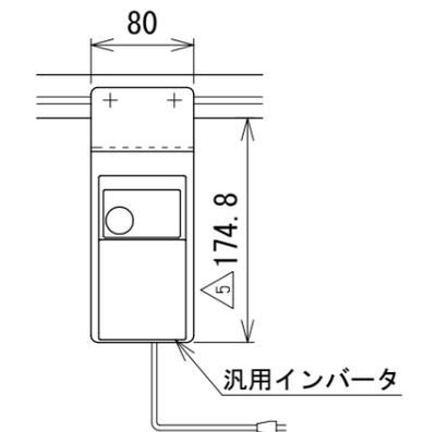
モータ飛び出し寸法表 M(最大値) 単位 mm
