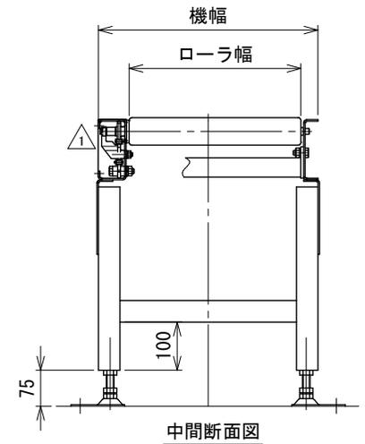
注1 本図は駆動チェーンの方向 Lタイプ（左側）とする
