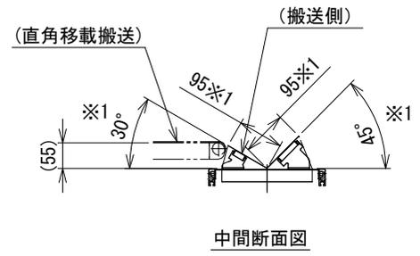
注1 本図は呼びベルト幅100 mm、モータ取付側L、搬送ベルト取付側BELの場合です
