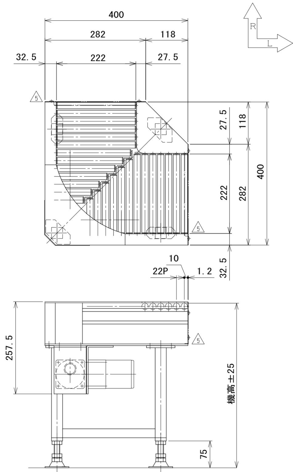
注1 2原動タイプの呼び幅200 mmはベースに電装部品が取付けできません
