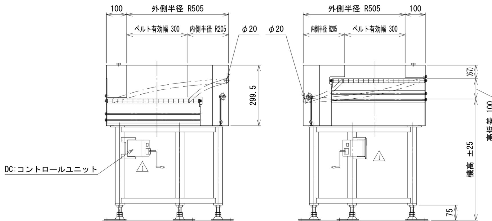
注1 本図は呼び幅300 mm、高低差100 mm、搬送方向U、回転方向Rの場合です
