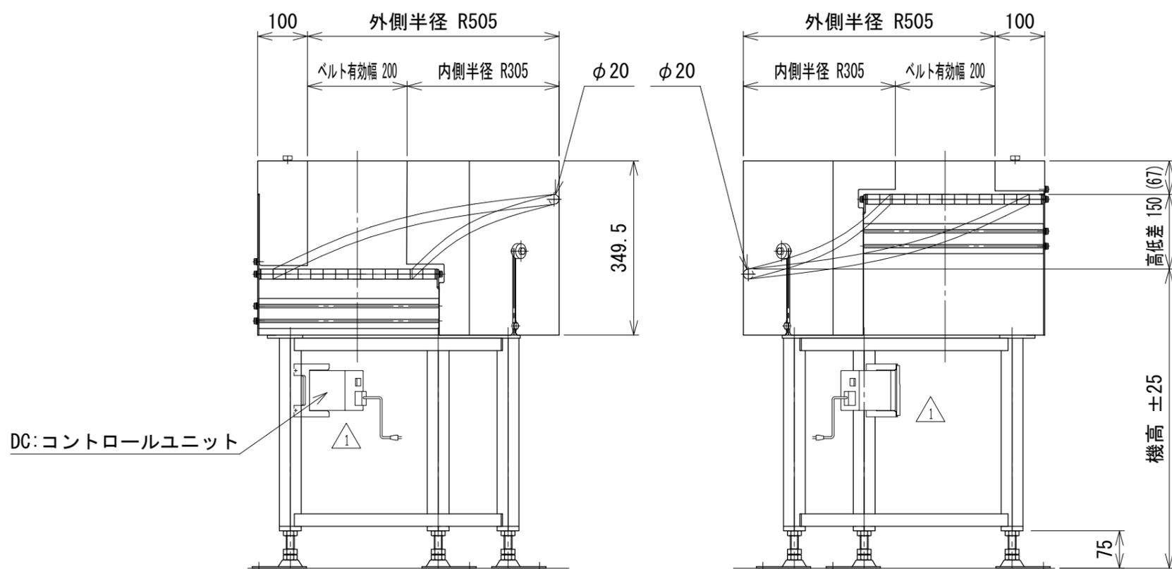
注1 本図は呼び幅200 mm、高低差150 mm、搬送方向U、回転方向Rの場合です
