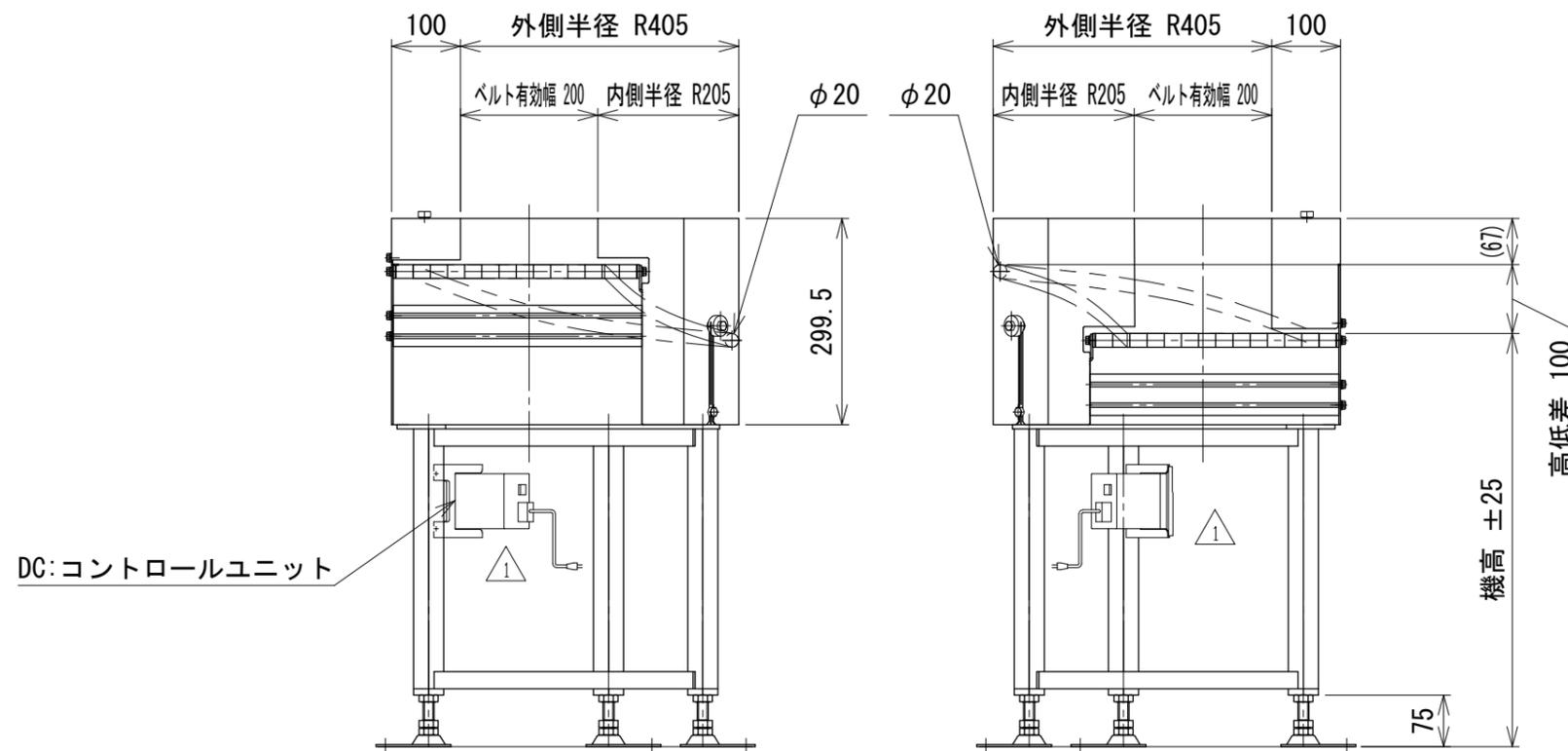
注1 本図は呼び幅200 mm、高低差100 mm、搬送方向D、回転方向Rの場合です
