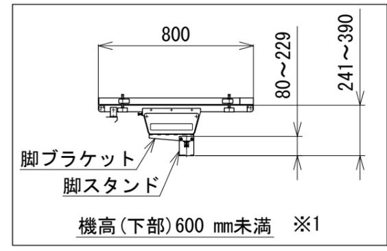
注1 本図は排出方向360°、揚程1855 mm、回転方向R、搬送方向U(上り)の場合です
