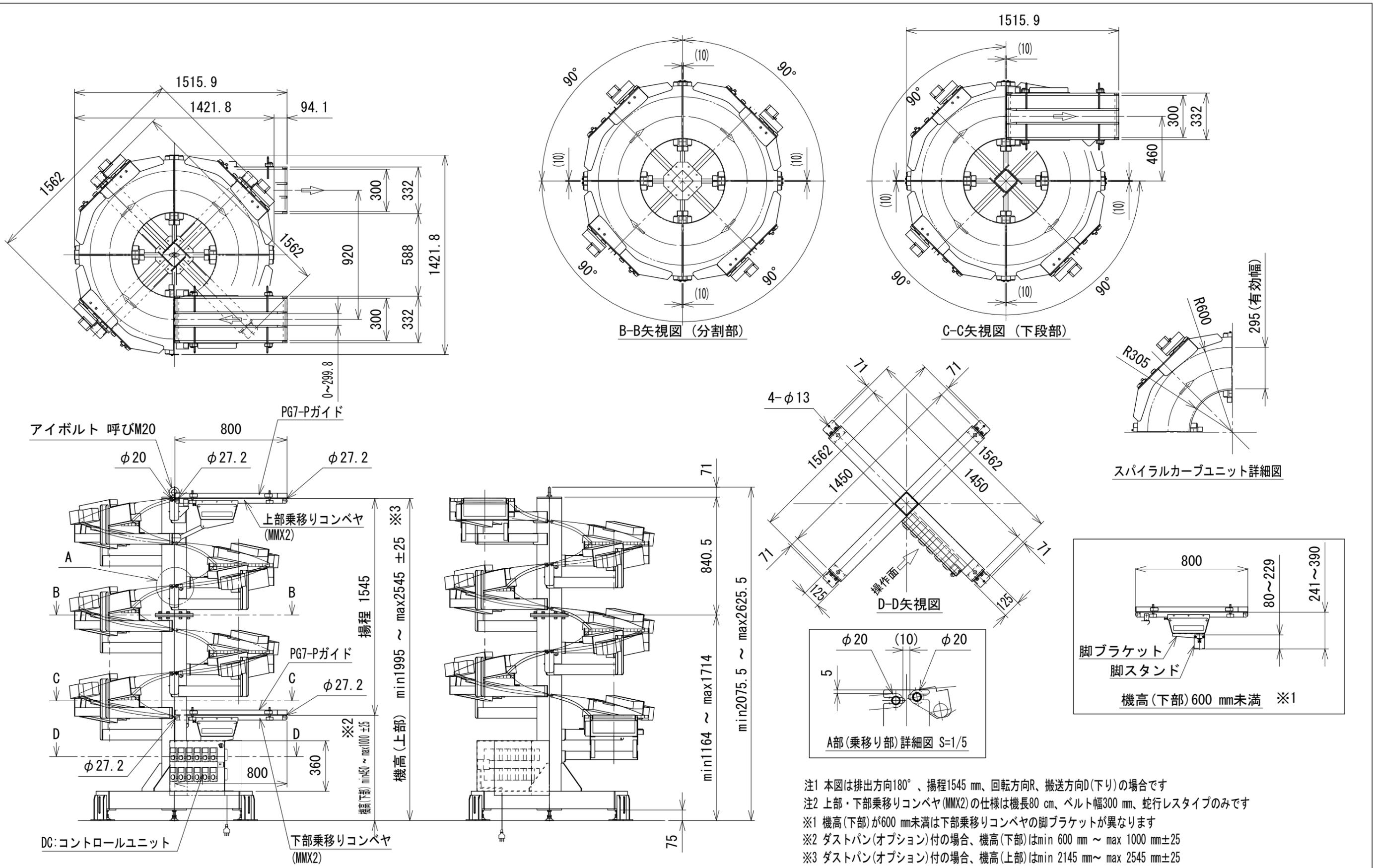
注1 本図は排出方向180°、揚程1545 mm、回転方向R、搬送方向D(下り)の場合です
