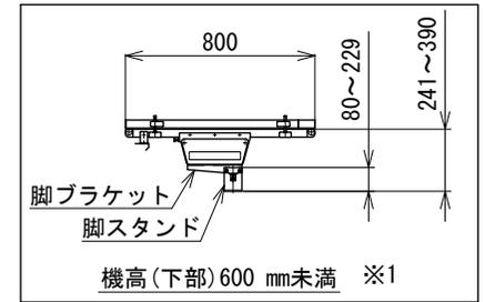
注1 本図は排出方向180°、揚程925 mm、回転方向L、搬送方向U(上り)の場合です
