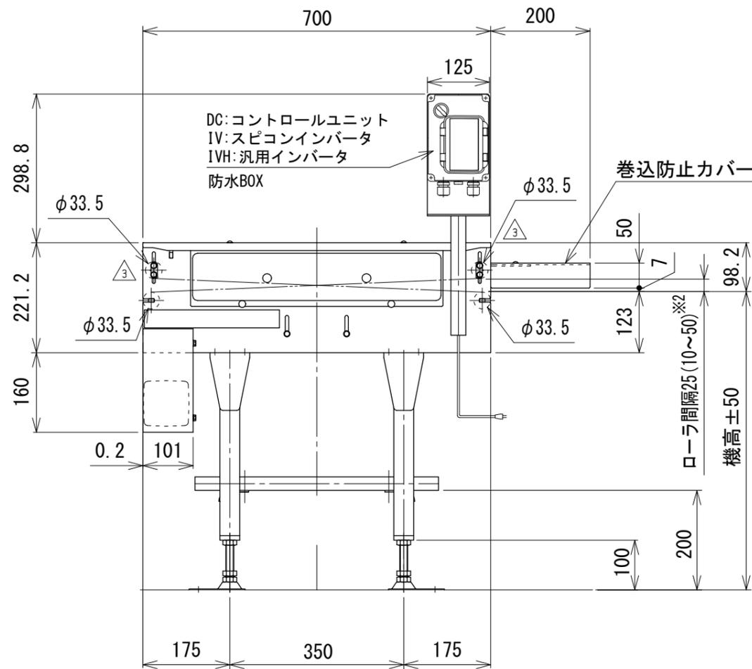
※1 正寸法はインバータ変速、( )寸法はDCモータ変速の場合です
