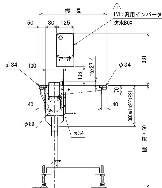
注1 本図は ベルト幅300 mm、モータ取付側L、操作面外側、汎用インバータ変速(モータ出力90 W) 傾斜用脚付の場合です
