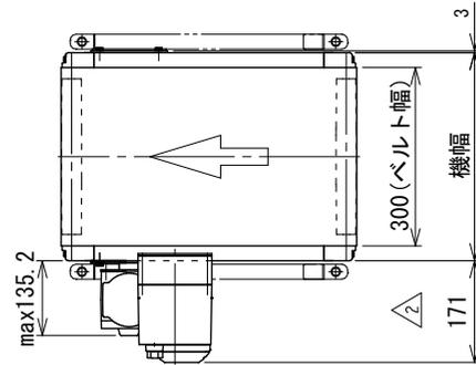
注1 本図は モータ取付側L, 操作面外側, インバータ変速(モータ出力90W)
