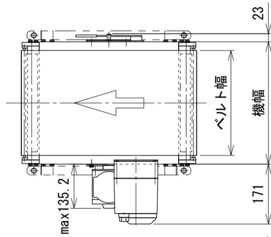
注1 本図はHS原動タイプ、ベルト幅300 mm、機長50 cm、機高750 mm、モータ取付側L、操作面外側インバータ変速(モータ出力90W)、傾斜用脚付の場合です
