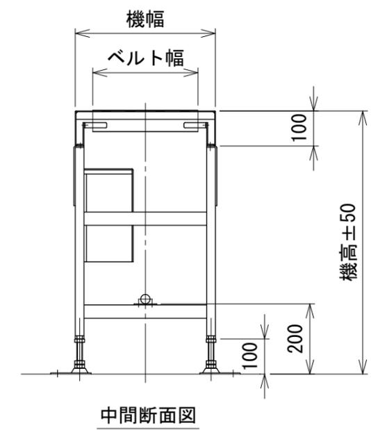
注1 本図はモータ取付側 L、モータ出力90 W、操作面外側、HA脚付の場合です
