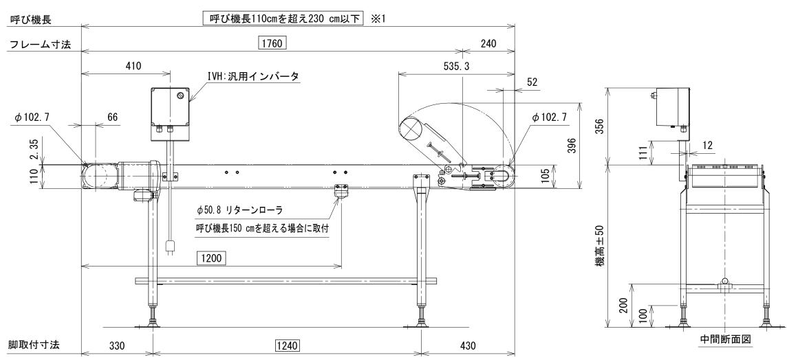
呼びベルト幅 200 300 500 600 400 ベルト幅 195 300 390 495 600
