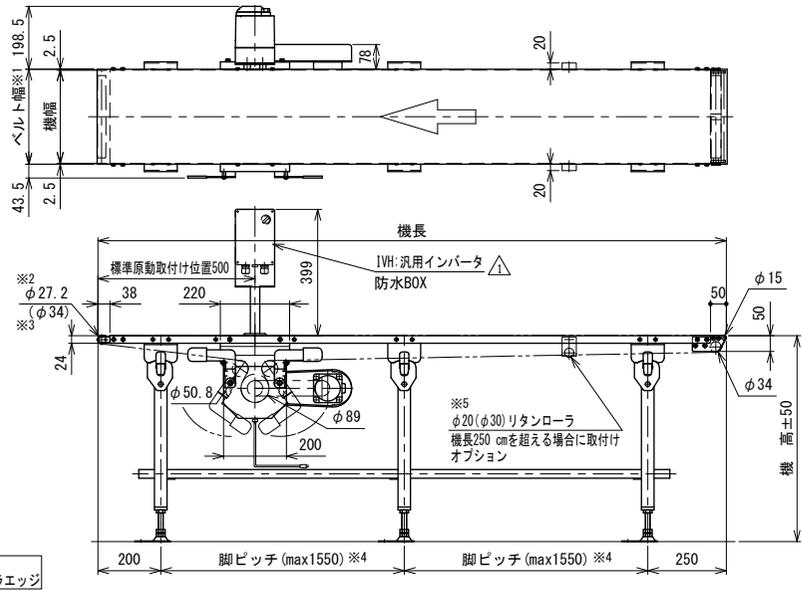
注1 本図は平行軸モータ下部取付ベルト着脱(UDT)タイプ、ベルト幅300mm、機長200cm、DCモータ変速(モータ出力90W)、HBA型脚、ステープ付の場合です
