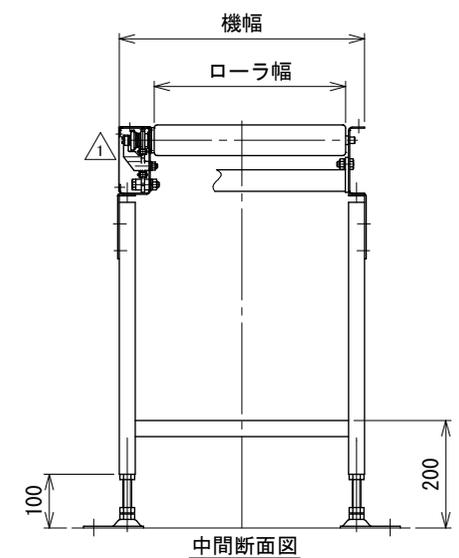
注1 本図はモータ0.4 kW取付、駆動チェーンの方向 Lタイプ (左側) の場合
