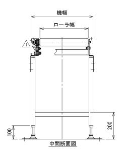
注1 本図はモータ0.4 kW取付、駆動チェーンの方向 Lタイプ (左側) の場合
