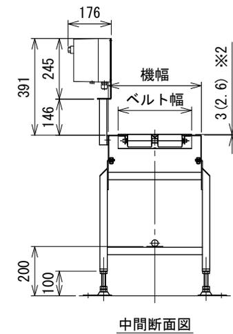
注1     寸法部のみ変更可能、その他の寸法は固定です。機長方向の変更は     寸法の範囲内で行ってください
