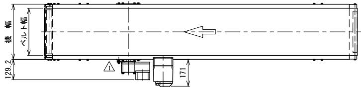
注1 本図はHS原動タイプ、ベルト幅300 mm、機長200 cm、機高650 mmの場合です
