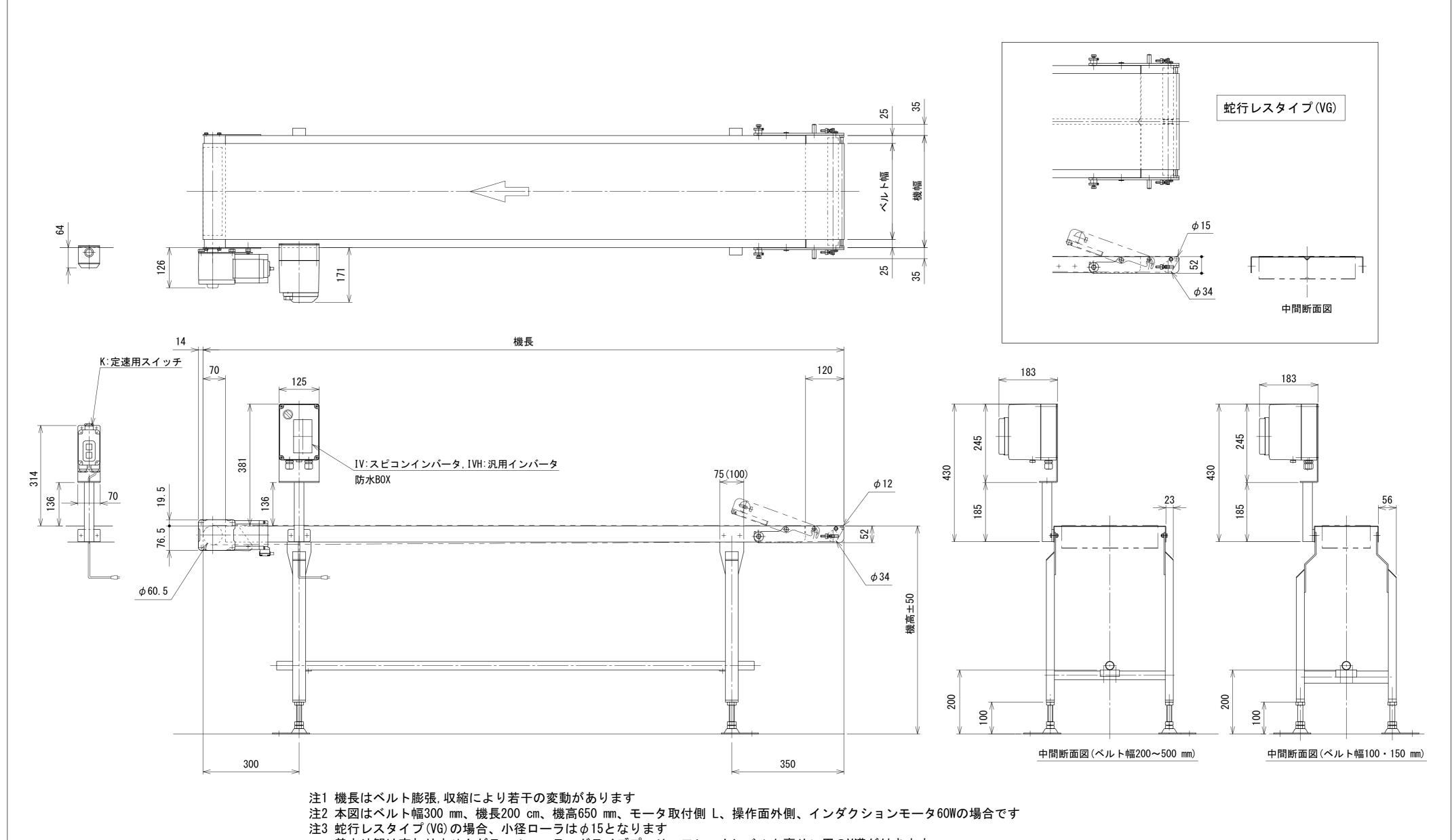
図名 本体組立図 HS ベルト幅100 mm~500 mm 機長100 cm以上300 cm以下
