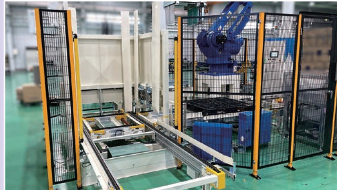
パレット用ローラコンベヤもお客様の工場に合わせ、より効率的な搬送ラインをご提案いたします。パレットマガジンも社内製作が可能。ロボットや電気制御も含めた設備全体で承ります。
